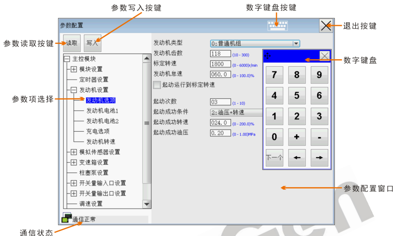
图9 主控模块参数配置界面
