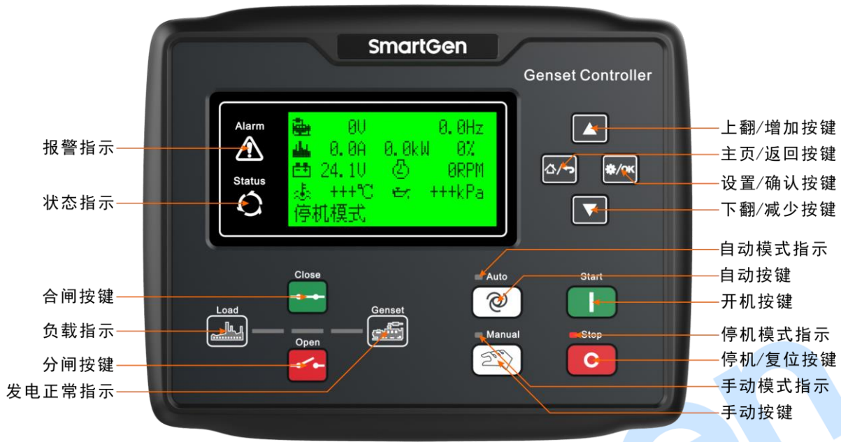
图1 HGM6110(HGM6110N/NC/CAN)前面板指示
