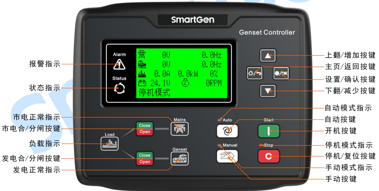
图2 HGM6120(HGM6120N/NC/CAN)前面板指示
